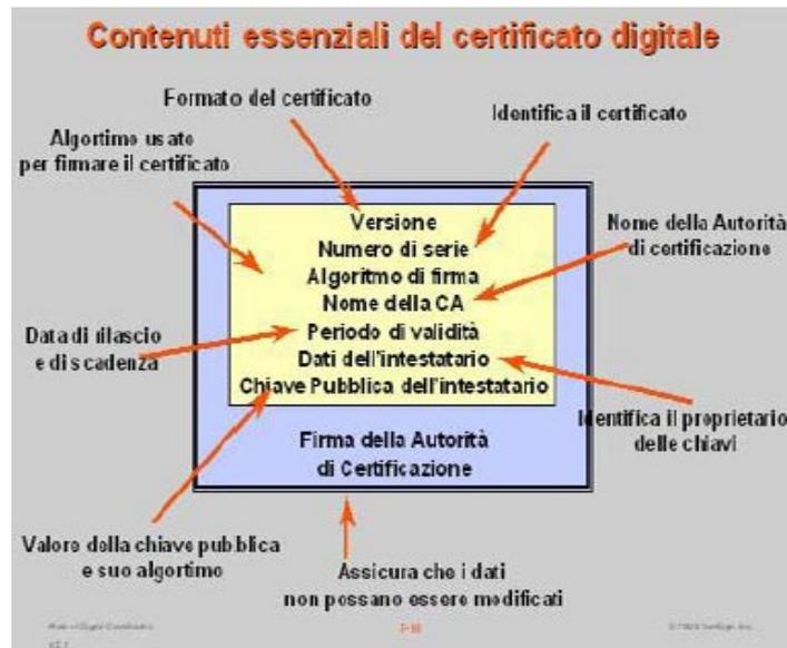
Figura 1 – La struttura di un certificato di firma
